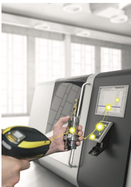
ZOLLER »ZidCode 4.0« è il sistema per l’identificazione degli utensili e la trasmissione dei relativi dati alla macchina utensile
